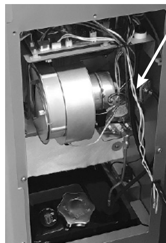
サーモ接続コード (ビニタイをほどき、エッジホルダに通した状態)
